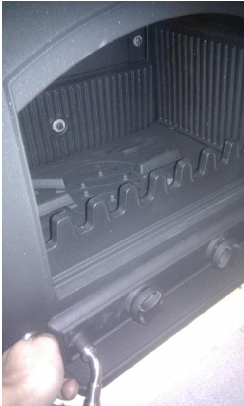
Ovan t.v: Räckflad insida i eldstaden för ökade konvektionsytor. Roster i botten som vrids med spak utifrån
